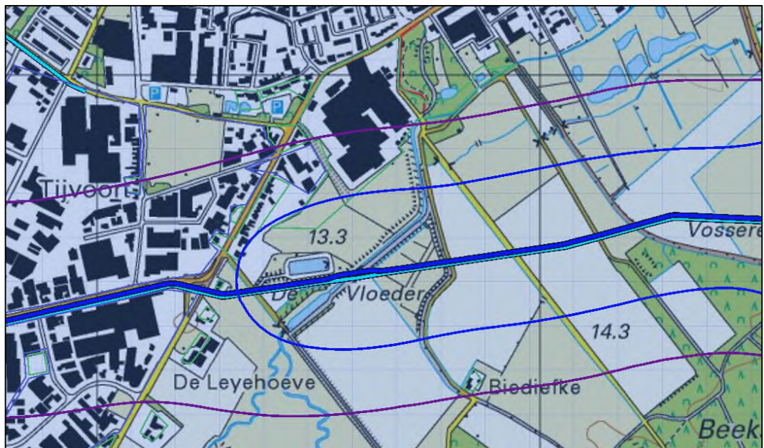
Figuur B1.3: PR 10^{-7} - (blauw) en PR 10^{-8} -contour (paars) van leiding A-532-1
