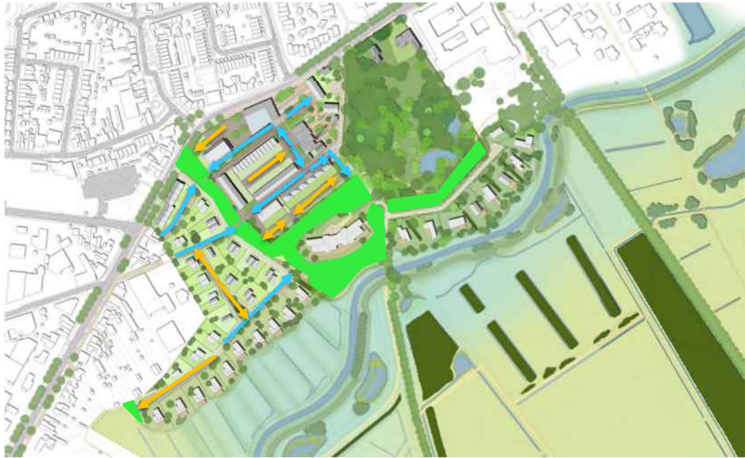
Figuur 10: Bovengrondse stroomrichting door goten (blauwe, gele, rode pijlen) met waterberging (groene vlakken)
