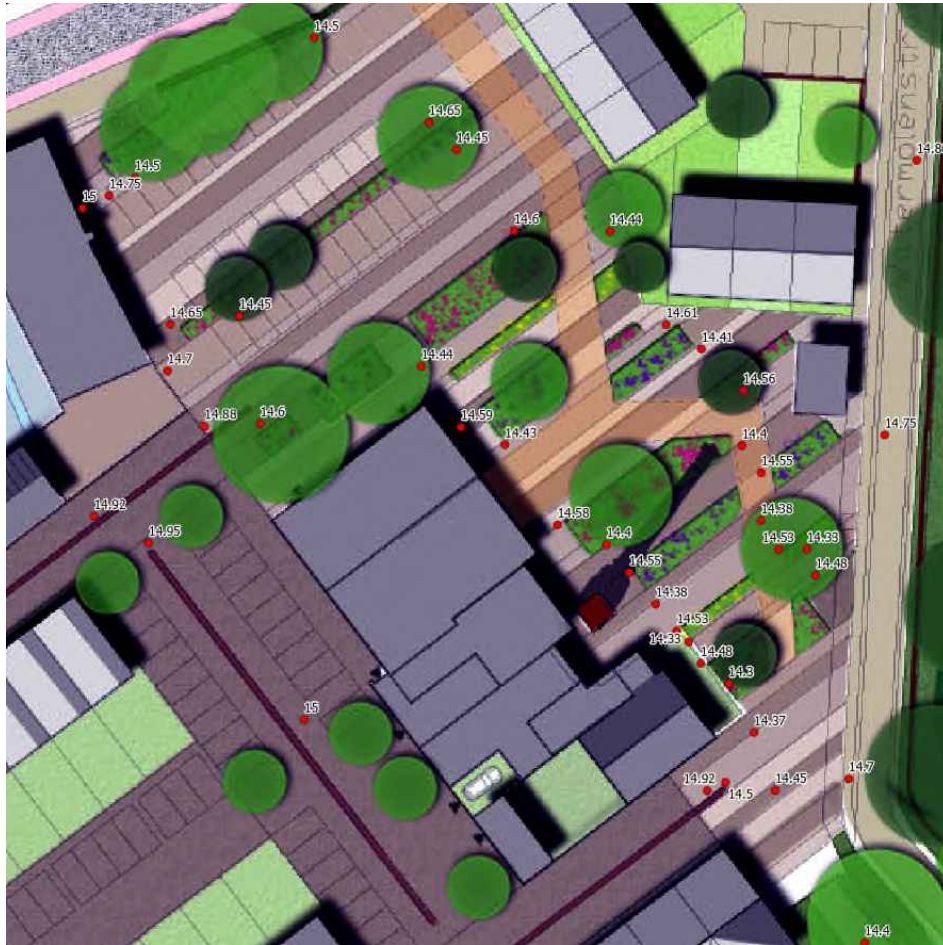
Figuur 13: Detail hoogtes waterplein
