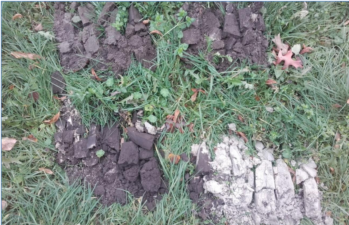
Afbeelding 11 Boring 8; een typerende boring. De scherpe overgang van de geroerde toplaag naar het moedermateriaal vindt plaats op 155 centimeter beneden maaiveld. Bron: foto Vestigia (01-11-2018).
