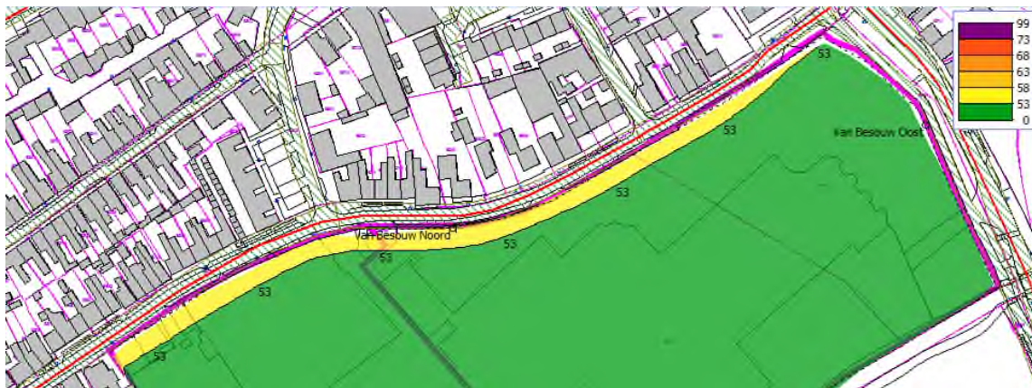
Afbeelding 2 Geluidcontouren locatie Van Besouw op 1,5 meter hoogte ten gevolge van de Kerkstraat (excl. aftrek ex art. 110g Wgh)
