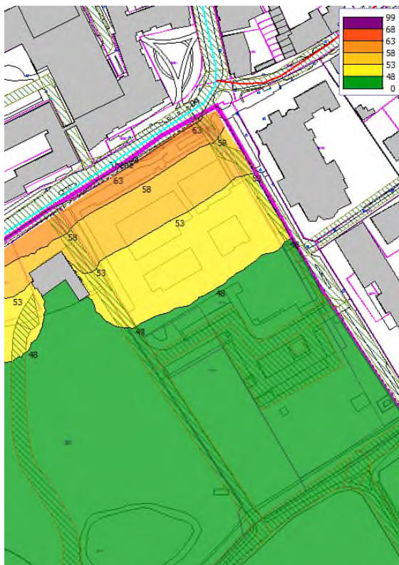
Afbeelding 3 Geluidcontouren locatie Thébe op 7,5 meter hoogte ten gevolge van de Bergstraat (incl. aftrek ex art. 110g Wgh)
