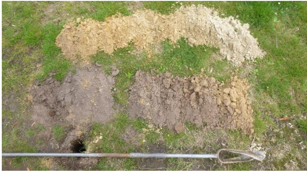
Afbeelding 10: overzicht Boring B001 (de top-lagen liggen onder).
