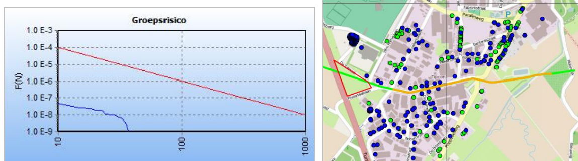
Figuur 9 FN curve van de kilometer met de hoogste overschrijdingsfactor van de A-532. De ligging van de kilometer met de hoogste overschrijdingsfactor is hiernaast in het oranje weergegeven op een topografische kaart.
