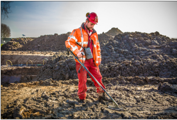
Figuur 5. Uitvoeren actieve realtime oppervlakedetectie en een staafdiagram waarop het maximale detectiebereik ( m^3 – maaiveld) per kaliber.
