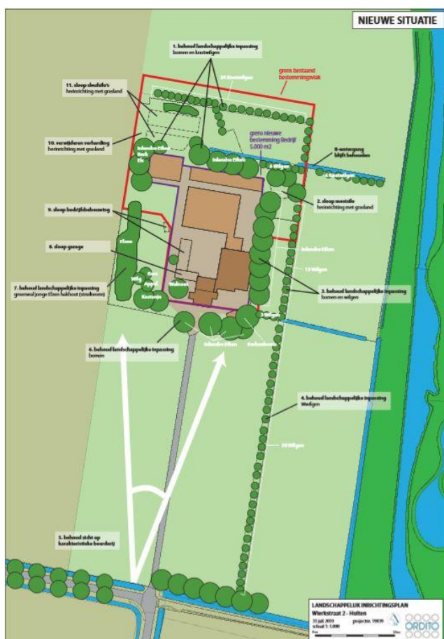
Afbeelding 2: Beoogde situatie bouwblok 5000m2.
