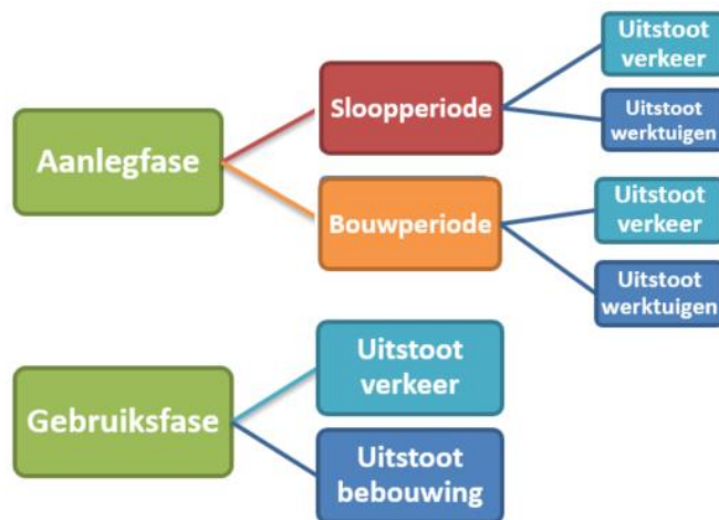
Afbeelding 3: Indeling aanlegfase en gebruiksfase
