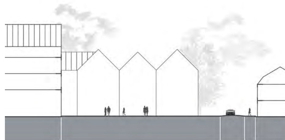
principe profiel centrumcluster 2 pandsgewijze opbouw met kappen, kapstructuur is indicatief wisselende pandbreedtes
