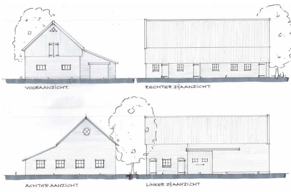
Bestaande toestand gevels grote schuur
