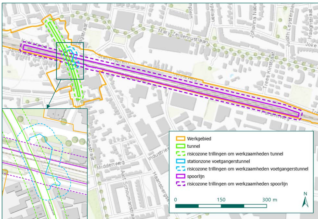
Figuur 13: Risicozones trillingen rondom werkzaamheden.
