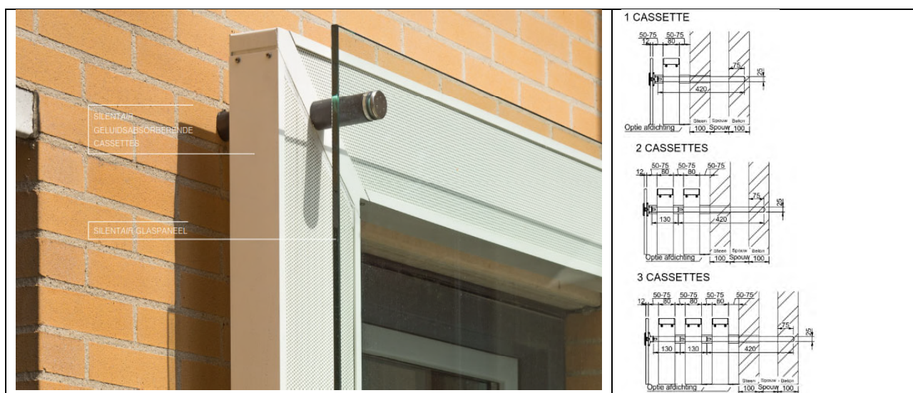
Figuur 6.7: Voorhangschermen (hier: Metaglas 'Total Glas Silentair')
