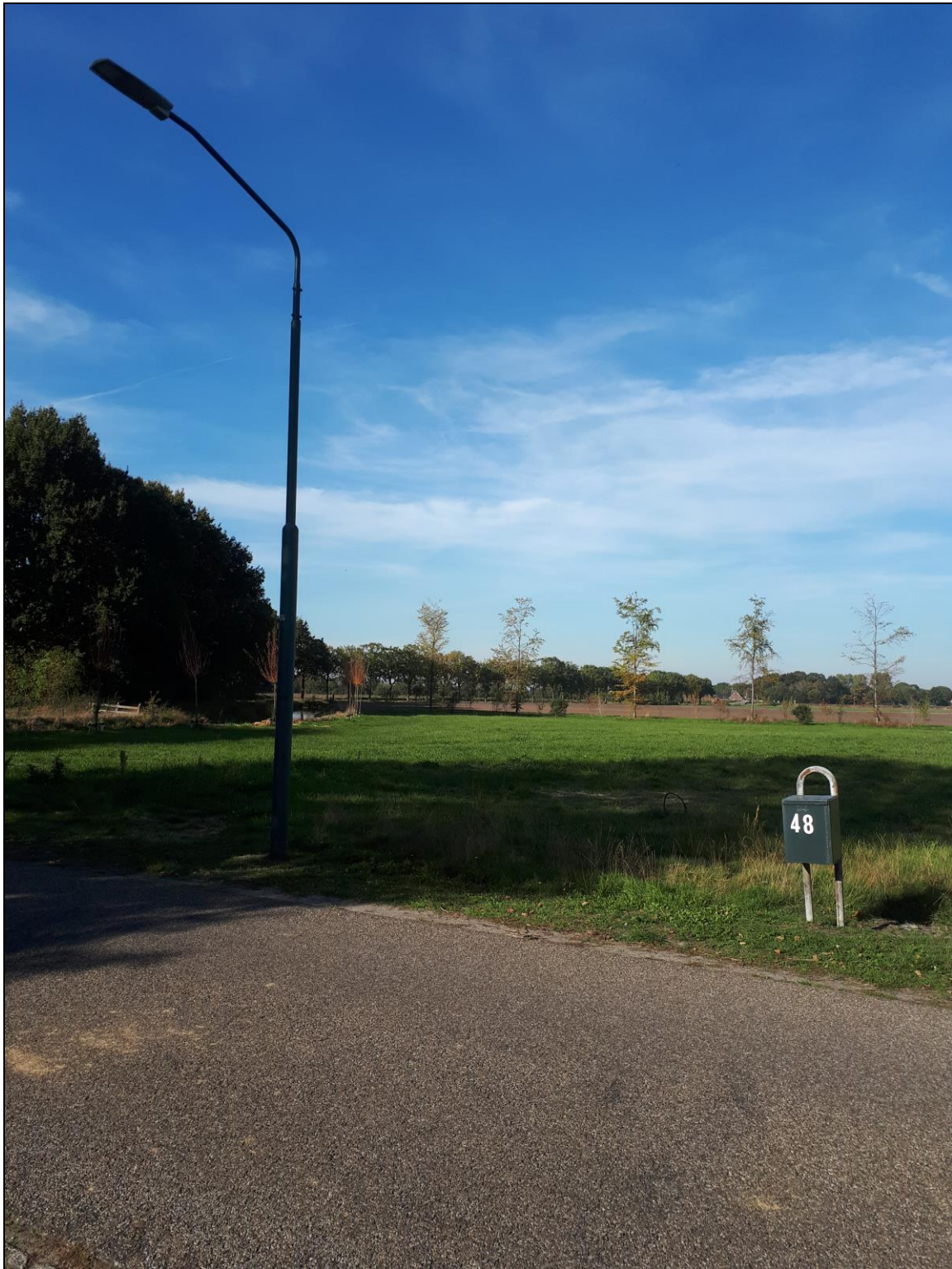
Figuur 6. Veld 2: een Lantaarn en een brievenbus veroorzaken de verstoringen die met op figuur 5 zijn omcirkeld (oranje ovaal). (Foto Bom-be).
