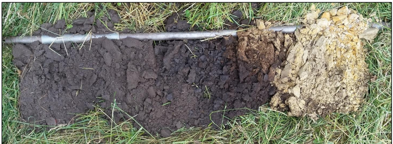
Figuur 9: De van links naar rechts uitgelegde boring 5. De lege ruimte in het midden markeert 50cm boordiepte. Duidelijk zichtbaar is de (bruinrood gekleurde) B-horizont, vanaf ca. 55cm tot 60 centimeter onder maaiveld, waarboven zich een restant van de E-horizont bevindt.
