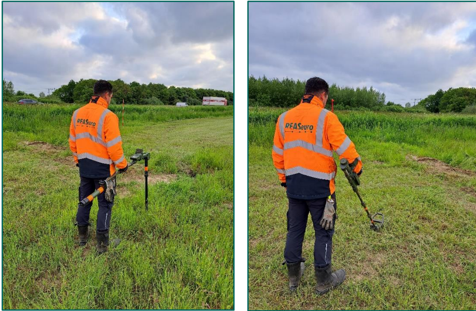
Figuur 3 en figuur 4: Foto's ter illustratie van detecteren met een passieve detector, de Vallon VX-1 (linkse figuur) en het detecteren met een actieve detector, de Vallon VMH-3CS (rechtse figuur).
