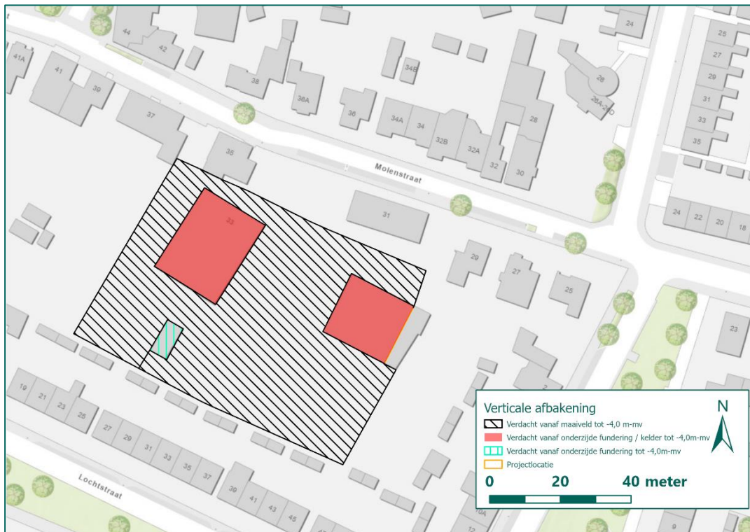
Figuur 13: Verticale afbakening ter plaatse van de projectlocatie, Gebieden die verdacht zijn vanaf maaiveld zijn bij verhardingen verdacht vanaf onderzijde cunet tot -4,0 m-mv.
