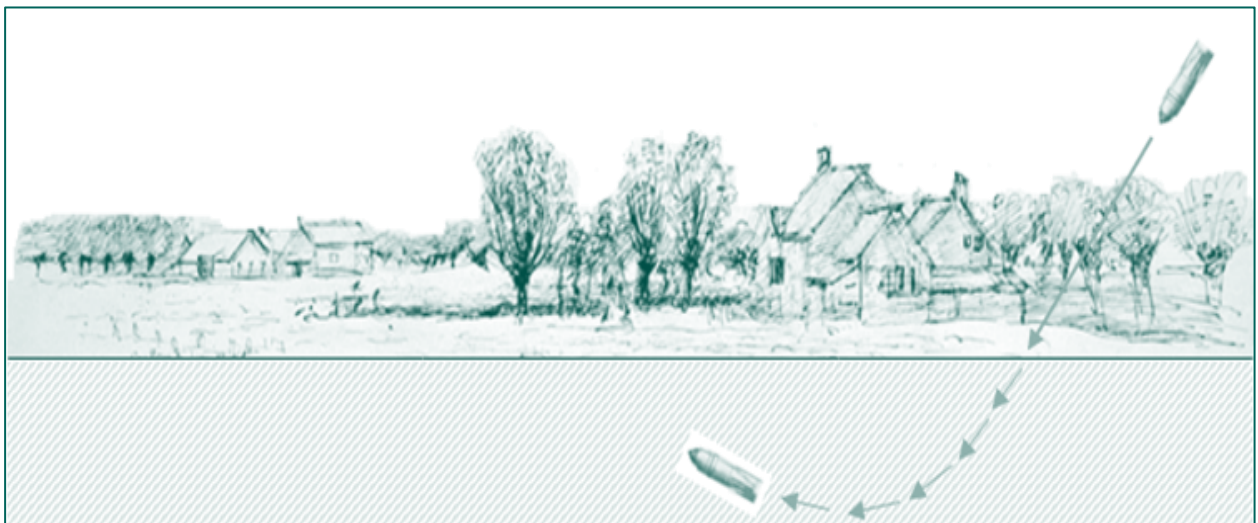
Figuur 15: Ondergrondse baan vliegtuigbom.
