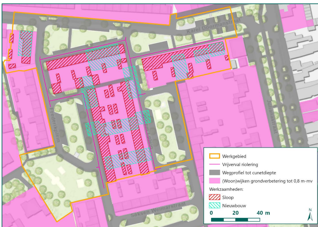
Figuur 7. Raakvlakken NGE verdachte bodemlaag wegprofiel, bestaande riolering en nieuwbouw.
