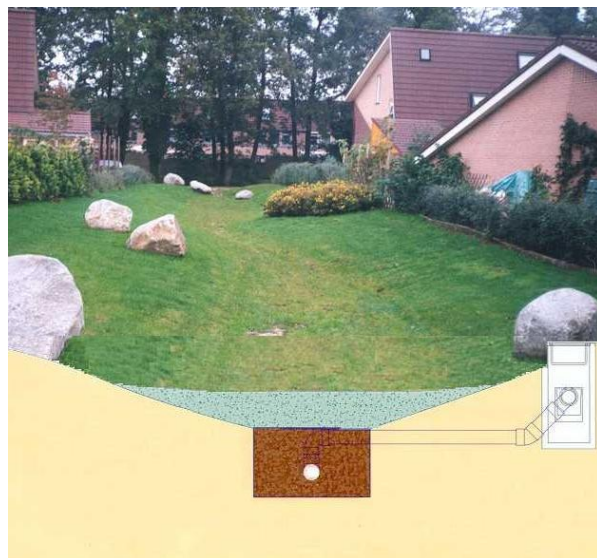
Afbeelding 7: Doorsnede en voorbeeld van een wadi.
