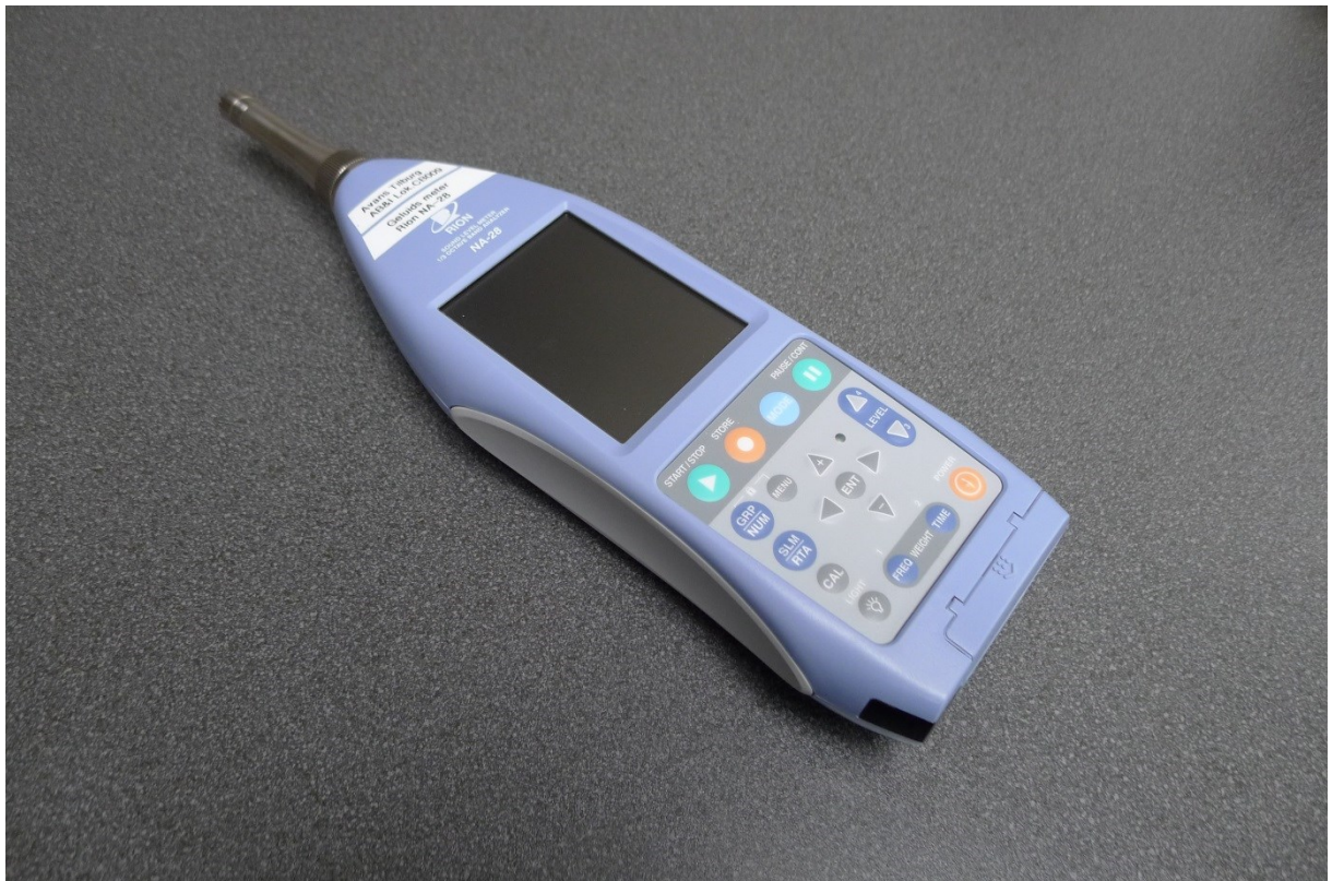
Bijlage 5.2a – Gebruikte geluidsmeter Rion NA-28(hier zonder windkap)
