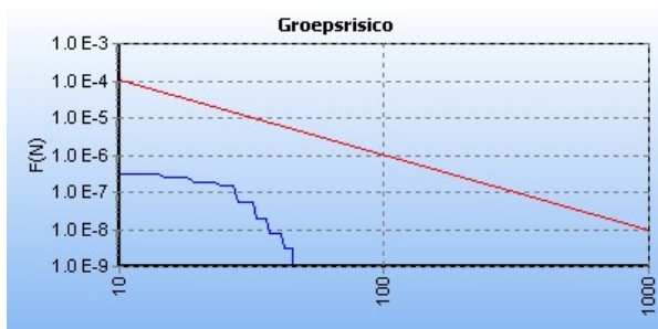
Figuur 5: FN curve van de kilometer met de hoogste overschrijdingsfactor (0,01) van de Z-528-07. De ligging van de kilometer met de hoogste overschrijdingsfactor is hiernaast in het groen weergegeven op een topografische kaart.
