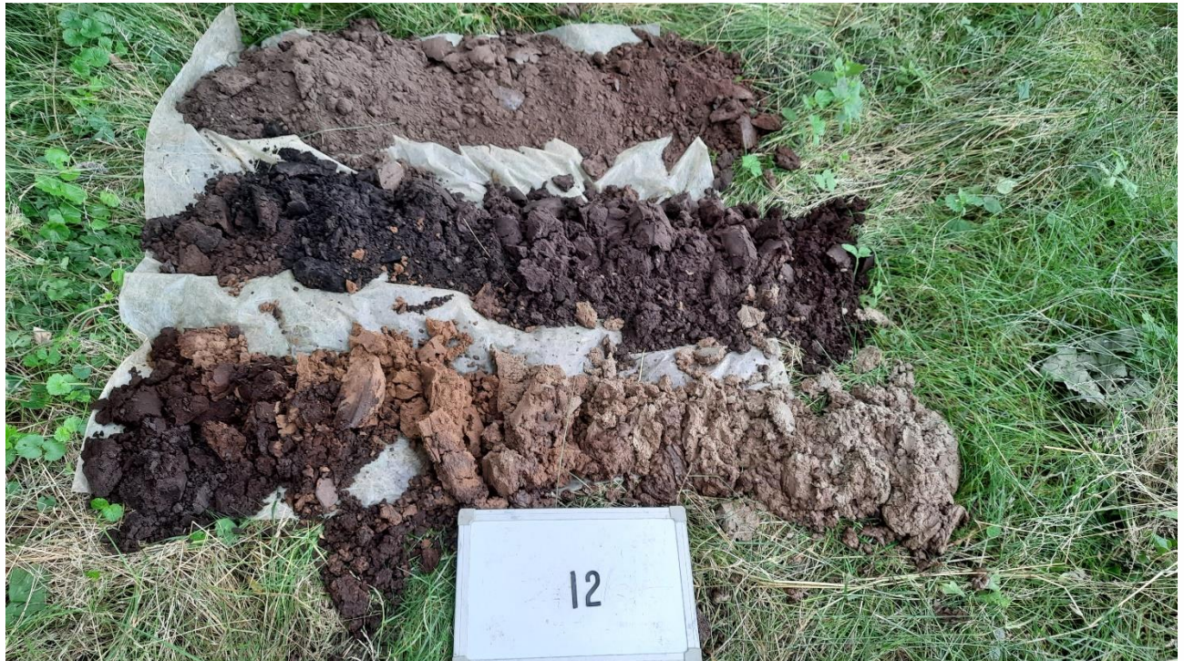
Afbeelding 5: Foto boorprofiel boring 12 tijdens veldwerk, zie boorbeschrijving in bijlage 5.
