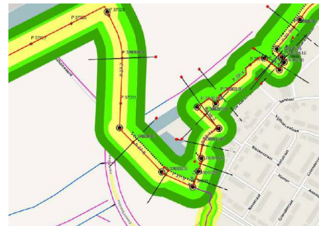
beschermingszones waterkering - waterstaatswerk (geel): in principe geen bebouwingmogelijkheden - beschermingszone A (lichtgroen): bouwen onder voorwaarden - beschermingszone B (donkergroen) ruimere bouw mogelijkheden
