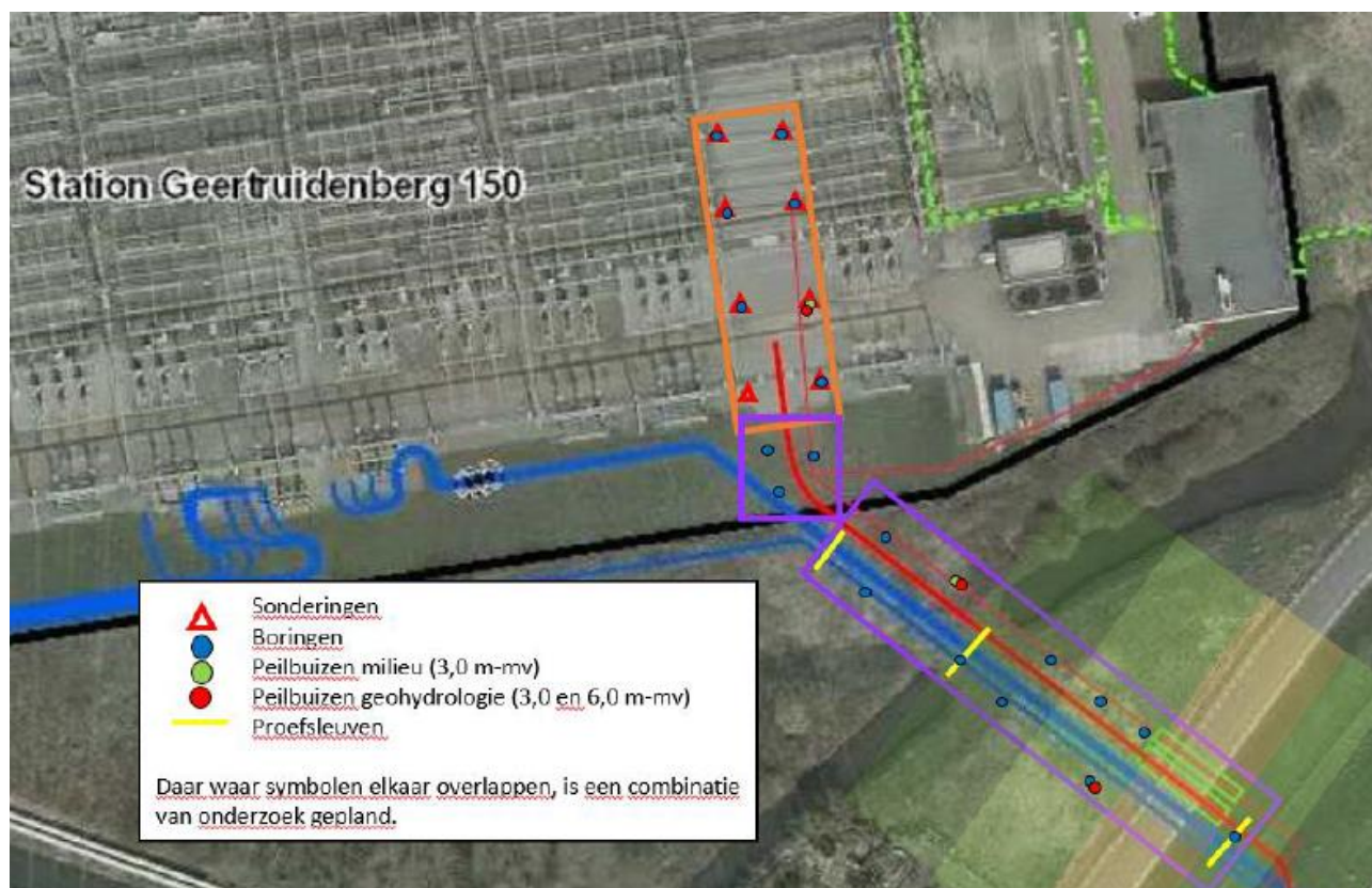
Figuur 16. Locaties boringen, peilbuizen, sonderingen en proefsleuven.
