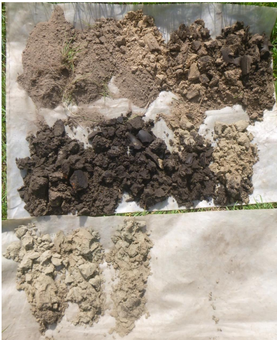
Fig. 3.1. Etten-Leur – Haansberg (Deelgebied 3 tijdelijke woningen). Boorprofiel boring 8 (0 – 120 cm onder maaiveld). Leesrichting van linksboven tot rechtsonder. (VUhbs d.d. 18-07-2023).
