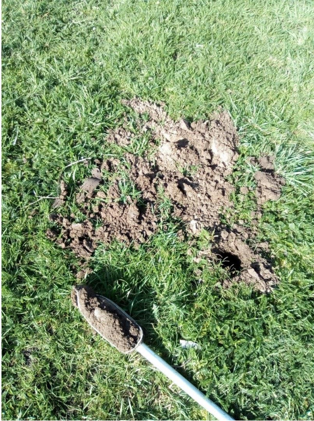
Fig.2 per boring grond visueel bekijken op veranderingen/ afval
