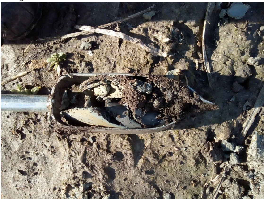
Fig.1 boring met overgang naar stortlaag
