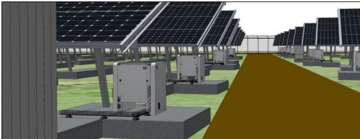
Rijen zonnepanelen met omvormers
