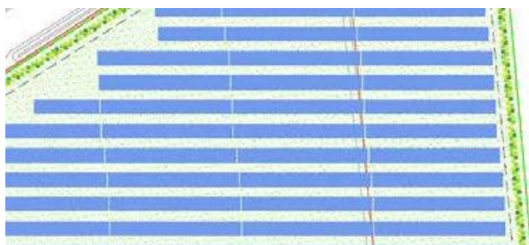
Detail opstelling rijen (indicatief) Tussenruimten 2,40 m
