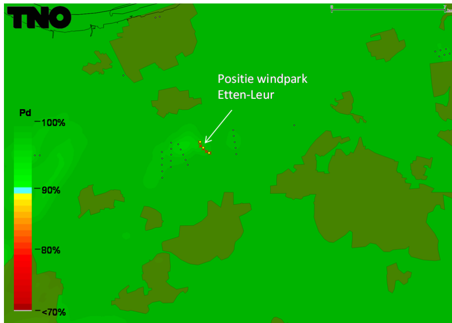
Figuur 7 Detectiekans van het MASS primaire verkeersleidingsradarnetwerk op 1000 voet boven het bouwplan nadat deze is gerealiseerd. De locatie van de verwijderde windturbines zijn aangegeven met rode kruizen en de nieuwe windturbines met gele stippen.
