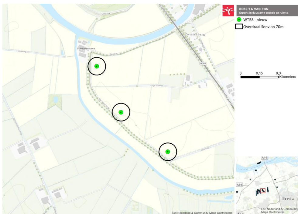
Figuur 2 – Overdraai van de windturbines van het beoogde windpark
