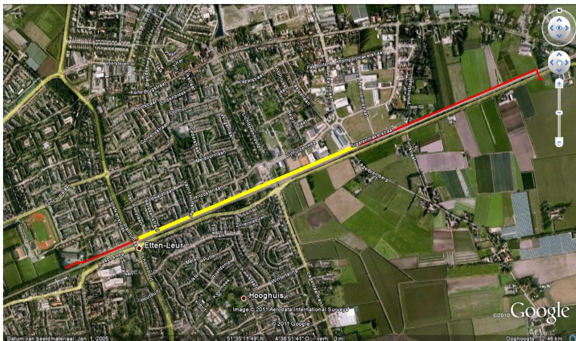
Figuur 3.1. Tracé aan te leggen gasleiding
