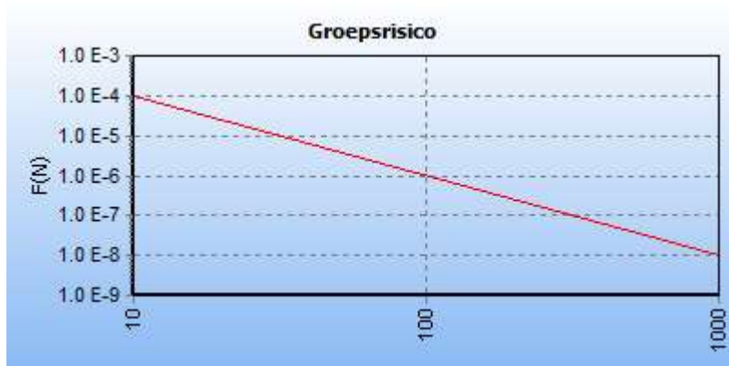
5.1 Figuur 5.1 FN curve voor 7155_leiding-Z-520-37-deel-1 van N.V. Nederlandse Gasunie voor de kilometer tussen stationing 1170.00 en stationing 2170.00
