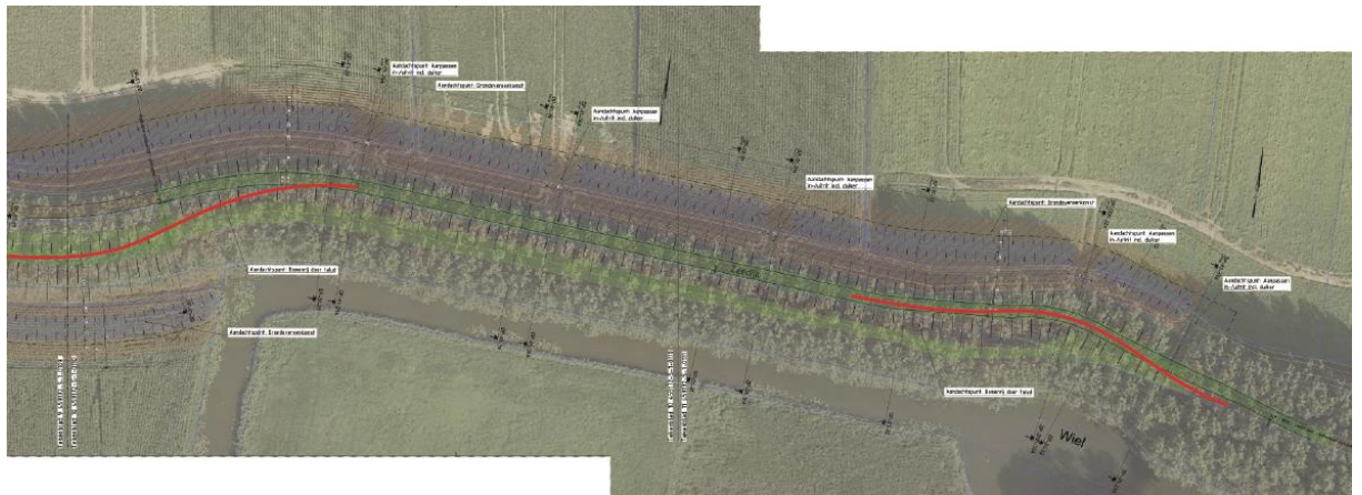
In het VKA is men voornemens om dit traject aan de buitendijkse zijde te versterken met behoud van het binnendijs gelegen wiel. De dijkverlegging geeft een mogelijkheid om de landschappelijke waarde van het kronkelige verloop te versterken. Dit resultaat wordt bereikt door ter hoogte van het wiel (1 op de kaart) de ronding van het wiel te volgen en accentueren. Zo ontstaat een landschappelijke afwisseling in het dijktracé van rechtstanden en bochten. In de bocht ter hoogte van de binnendijs en haaks op de dijk liggende wetering (2 op de kaart) kan de rijweg Zeedijk op de kruin van de nieuwe dijk komen te liggen. Aandachtspunt hierbij is dat de kruin wel breed genoeg uitgevoerd moet worden voor (landbouw)verkeer.
