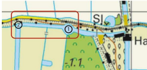
In het VKA is men voornemens om dit traject aan de buitendijkse zijde te versterken met behoud van het binnendijs gelegen wiel. De dijkverlegging geeft een mogelijkheid om de landschappelijke waarde van het kronkelige verloop te versterken. Dit resultaat wordt bereikt door ter hoogte van het wiel (1 op de kaart) de ronding van het wiel te volgen en accentueren. Zo ontstaat een landschappelijke afwisseling in het dijktracé van rechtstanden en bochten. In de bocht ter hoogte van de binnendijs en haaks op de dijk liggende wetering (2 op de kaart) kan de rijweg Zeedijk op de kruin van de nieuwe dijk komen te liggen. Aandachtspunt hierbij is dat de kruin wel breed genoeg uitgevoerd moet worden voor (landbouw)verkeer.
