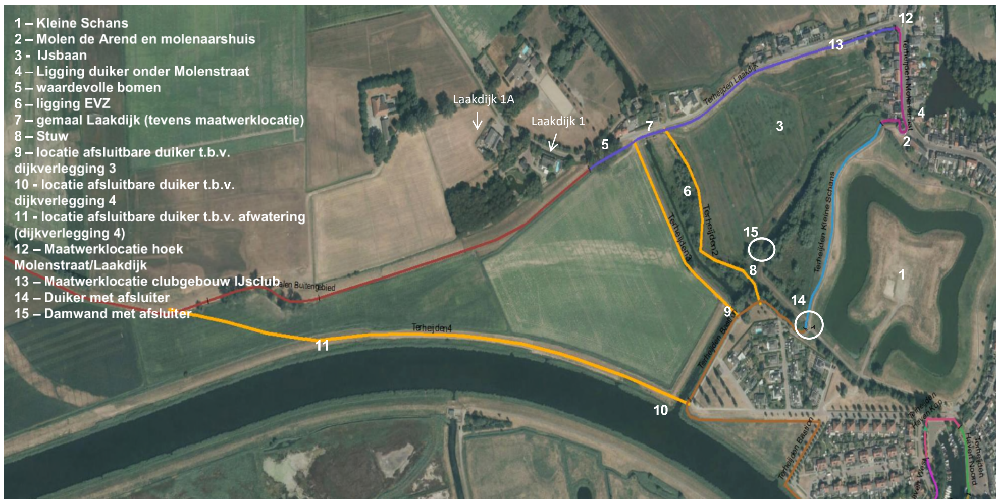
Figuur 36 Bovenaanzicht van deelgebied Molenstraat. De te verbeteren dijktracés zijn aangegeven in blauw, roze en paars. In oranje zijn de drie opties voor dijkverlegging weergegeven.
