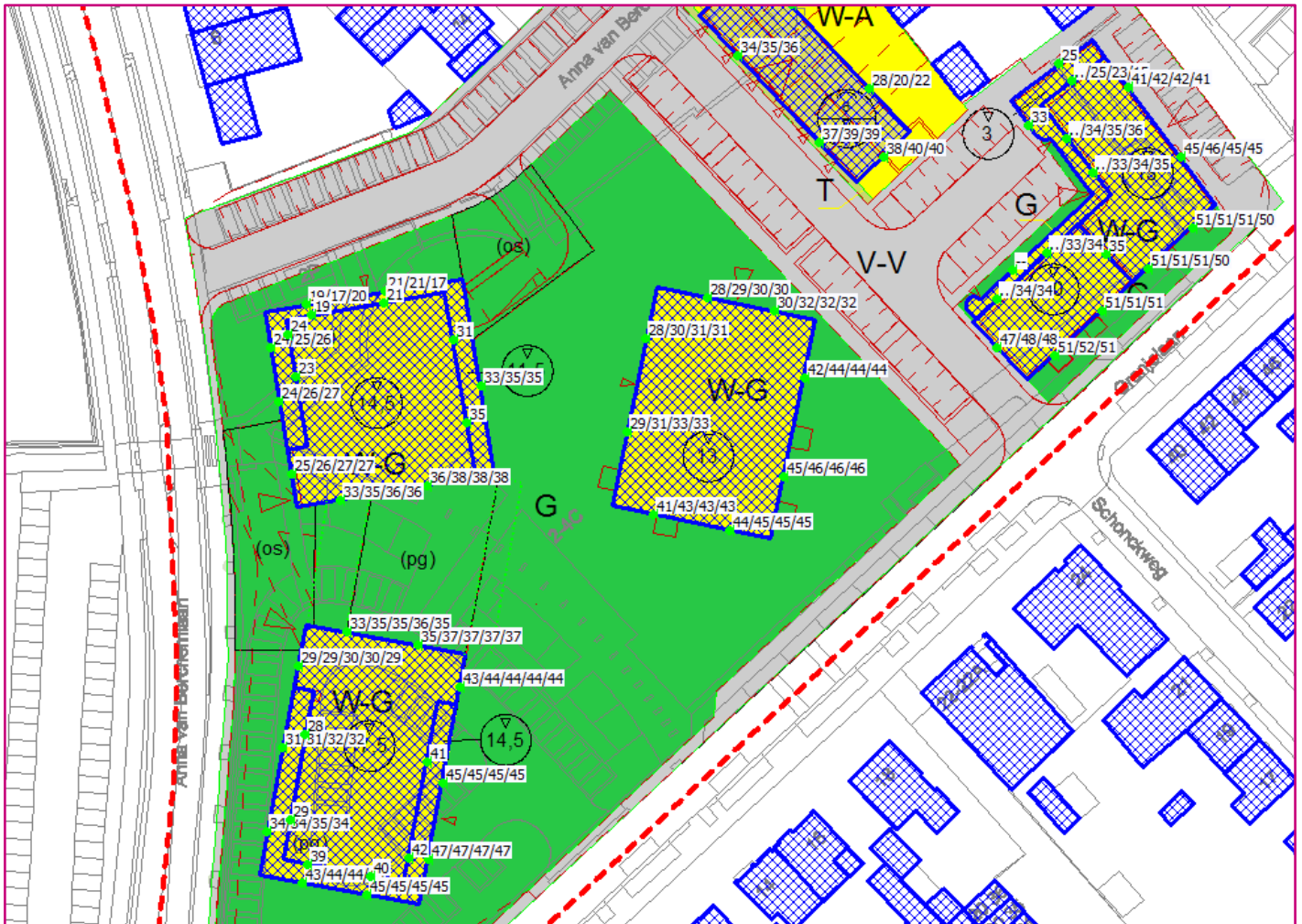
Figuur 4.2 Uitsnede van de geluidbelasting L_{den} in dB vanwege de Oranjelaan (inclusief aftrek artikel 110g Wgh)
