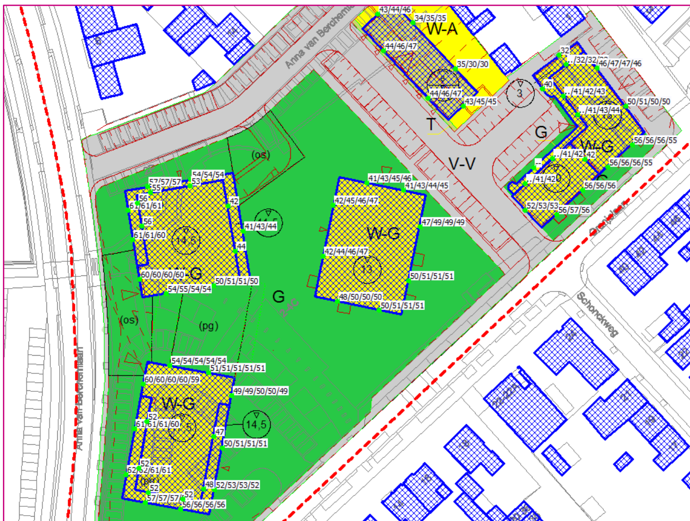
Figuur 4.3 Uitsnede van de cumulatieve geluidbelasting L_{den} in dB (exclusief aftrek artikel 110g Wgh)
