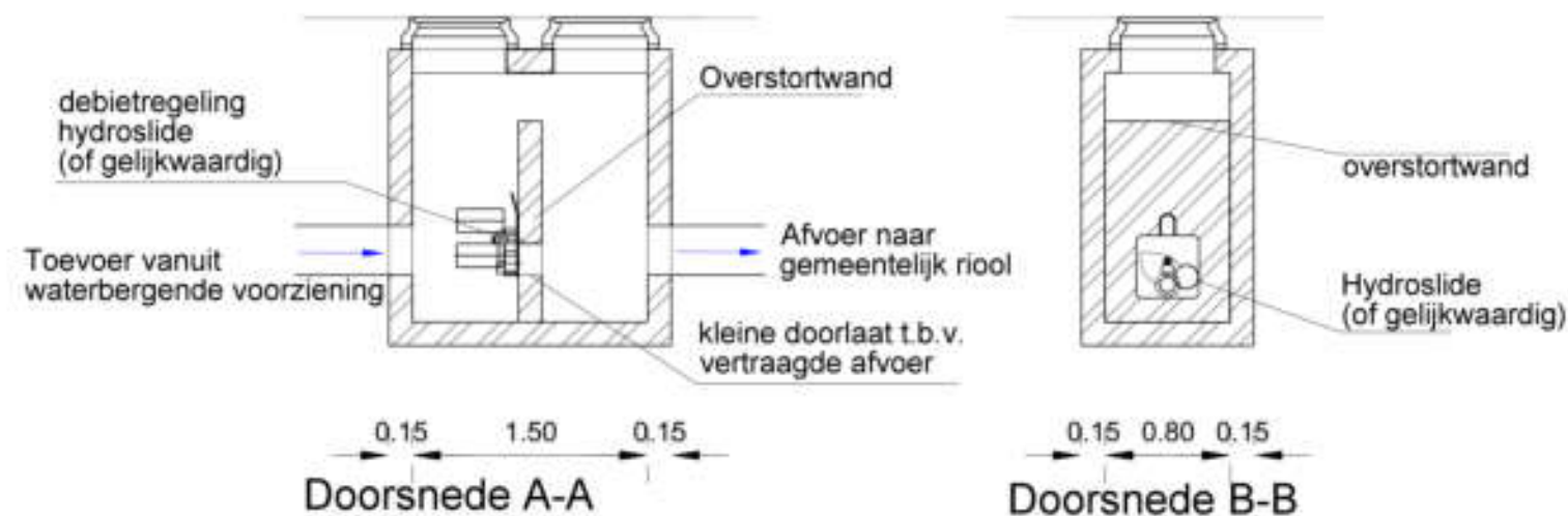
Detail A: principe overloop en leegloop
