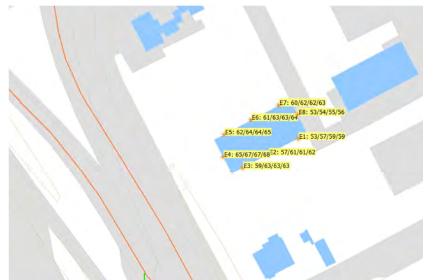
Figuur 6: Geluidbelasting in dB t.g.v alle wegen tezamen zonder aftrek conform artikel 110g Wgh.
