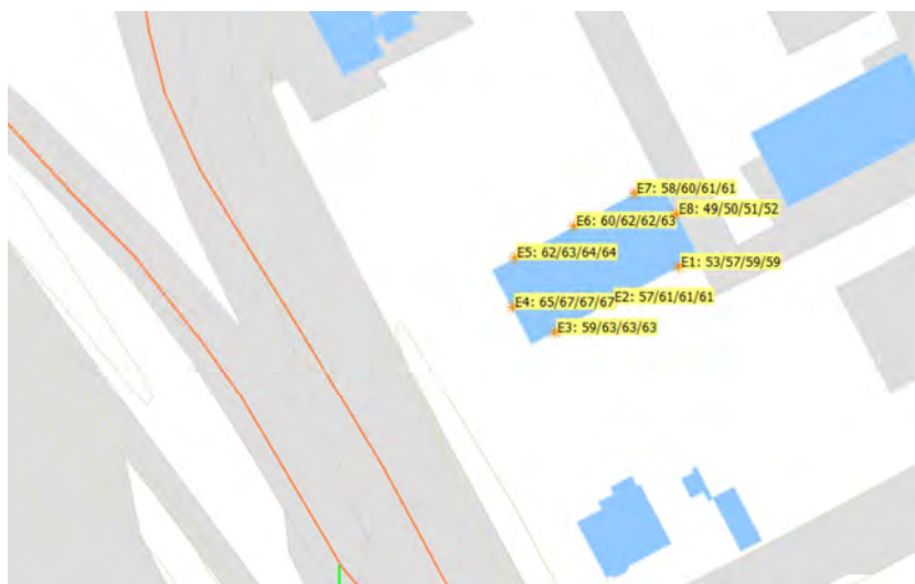
Figuur 4: Geluidbelasting in dB t.g.v de Insulindelaan zonder aftrek van 2 dB conform artikel 110g Wgh.
