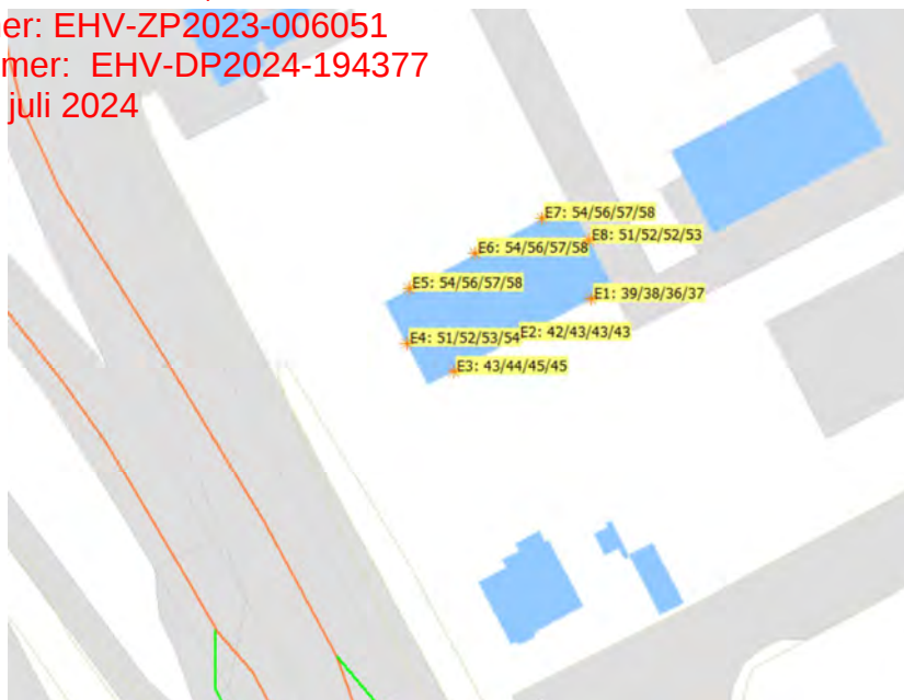
Figuur 5: Geluidbelasting in dB t.g.v de Eisenhouwerlaan zonder aftrek van 5 dB conform artikel 110g Wgh.
