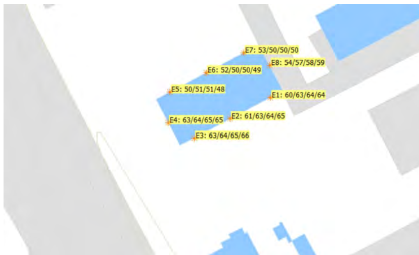
Figuur 7: Geluidbelasting in dB t.g.v het spoorweglawaai
