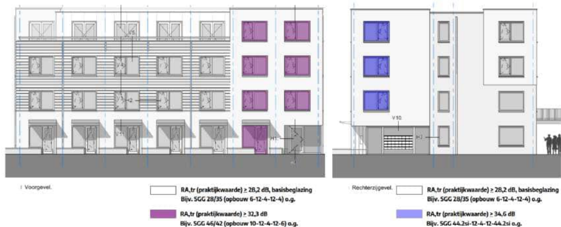
Figuur 3: Overzicht posities geluidisolerende beglazing
