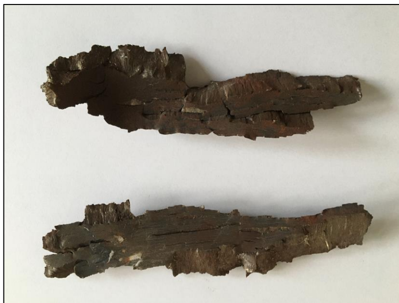
Afbeelding 29: Scherven na detonatie van een met springstof gevuld OO.
