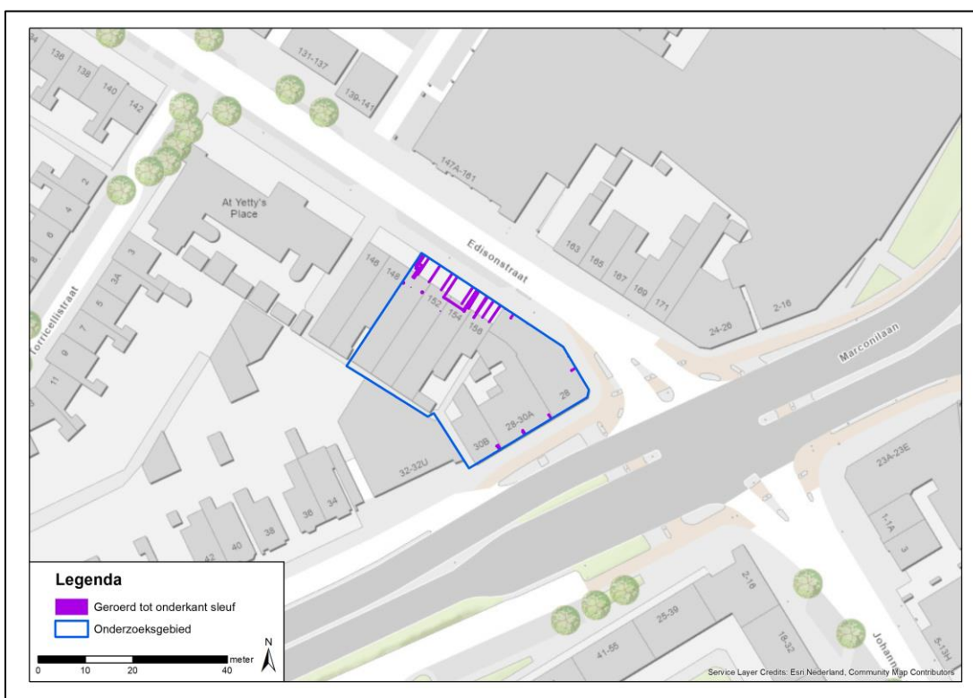
Afbeelding 12: Overzicht geroerde gronden kabels en leidingen.
