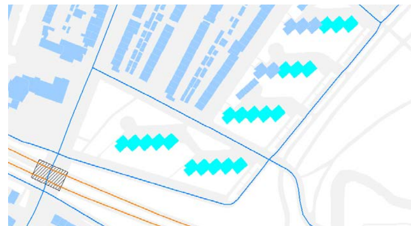
Figuur 6: Locaties waar op de nieuwe bovenste bouwlaag de voorkeursgrenswaarde van 48 dB wordt overschreden.
