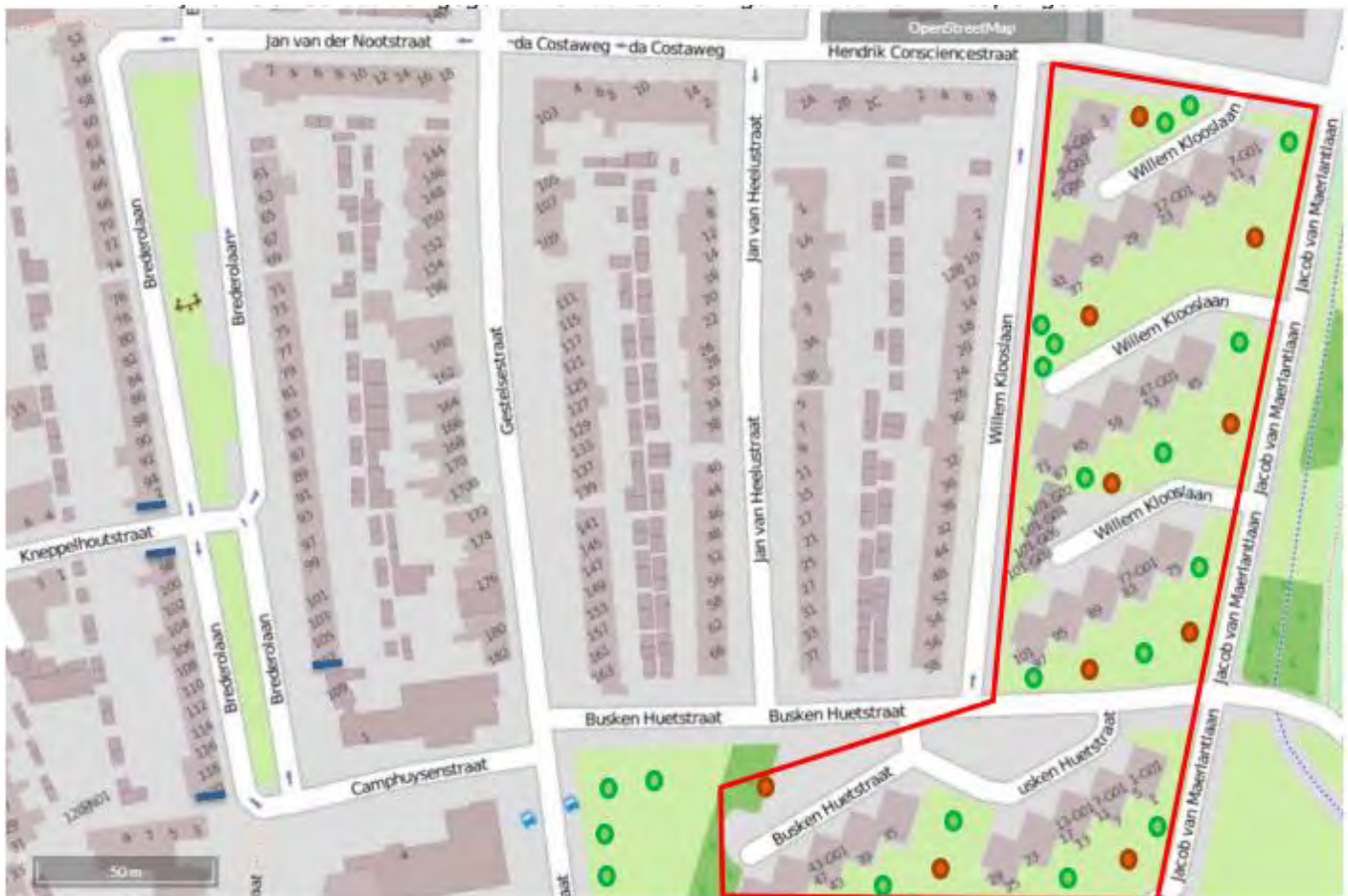
Figuur 2. Locaties tijdelijke vleermuiskasten (blauwe streep = 3 kasten per gevel, rode stip = paalkast, groene stip = benadering van de locaties van 1 à 2 kasten aan bomen) t.o.v. projectgebied (rode kader).
