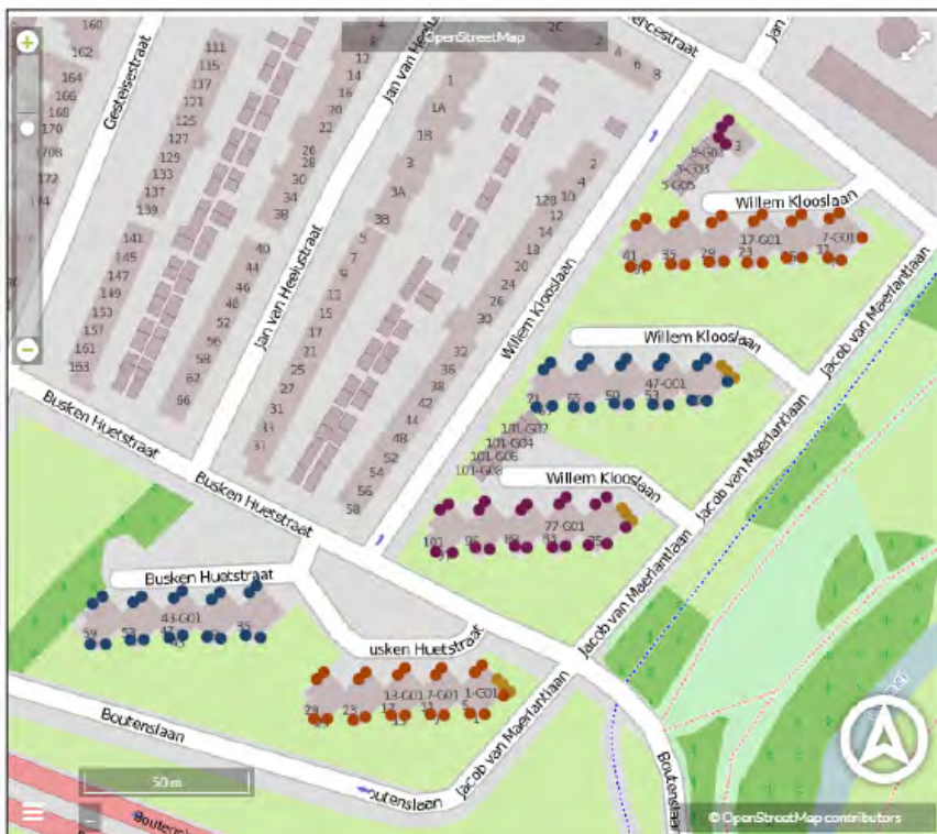
Figuur 4 Locaties van de permanente voorzieningen voor de gewone dwergvleermuis en ruige dwergvleermuis. Blauw zijn IB VL 05 van Vivara Pro (41x), Oranje zijn VMPM1 van Unitura (46x) en paars zijn Kleine Tichelaar van Tichelaar (25x). Daarnaast zijn de licht bruine stippen de locaties waar gierzwaluwkasten worden ingebouwd.
