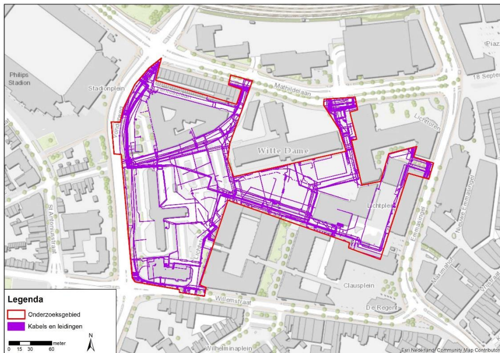
Afbeelding 11: geroerde gronden door naoorlogs gegraven kabels- en leidingensleuven in het werkgebied Emmasingelkwadrant.
