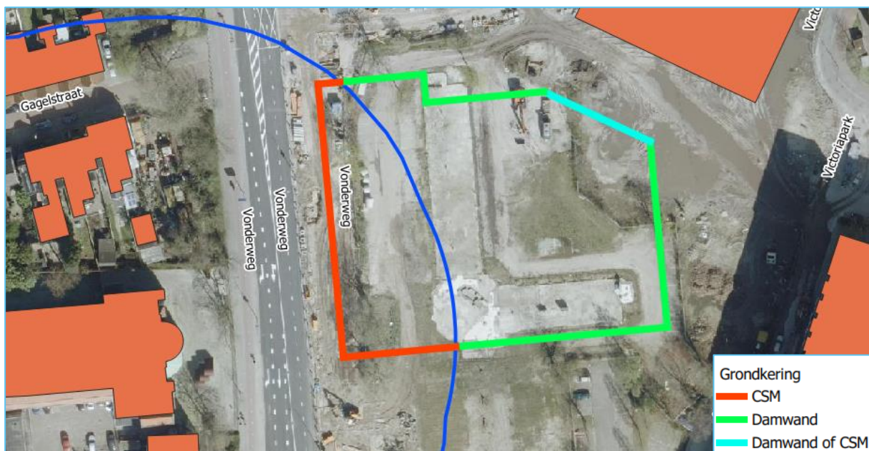
Figuur 5-4: Typen grondkeringen van bouwveld B i.v.m. de afstand tot de Steentjeskerk (buffer 50 m met blauwe lijn)
