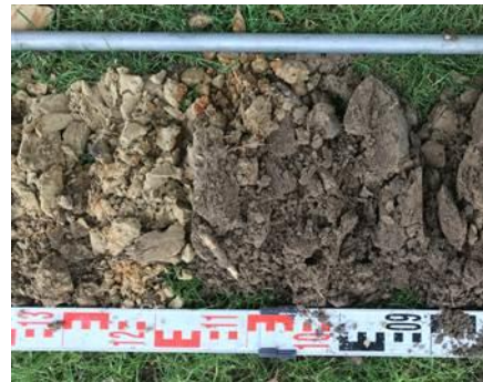
Afbeelding 7: roestvlekken in grondboring op 110 cm-mv
