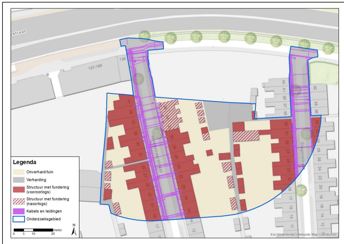
Afbeelding 17: Samengevoegde situaties uit 1945, 1961, 2002 en huidig, inclusief de kabels en leidingen.
