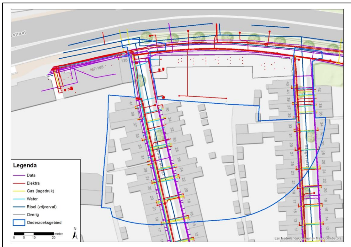
Afbeelding 10: Overzicht ligging huidige kabels en leidingen.
