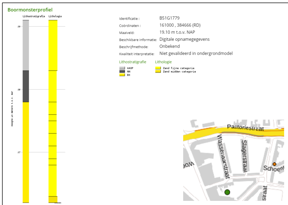
Afbeelding 24: Bodemprofiel (bron: DINOloket). Het boorpunt is aangegeven met de groene stip.
