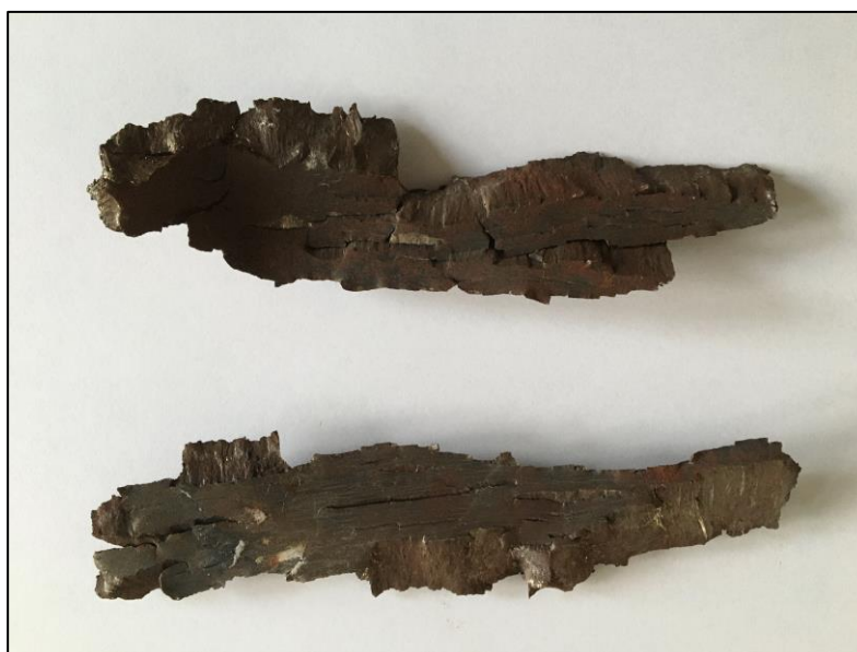
Afbeelding 28: Scherven na detonatie van een met springstof gevuld OO.
