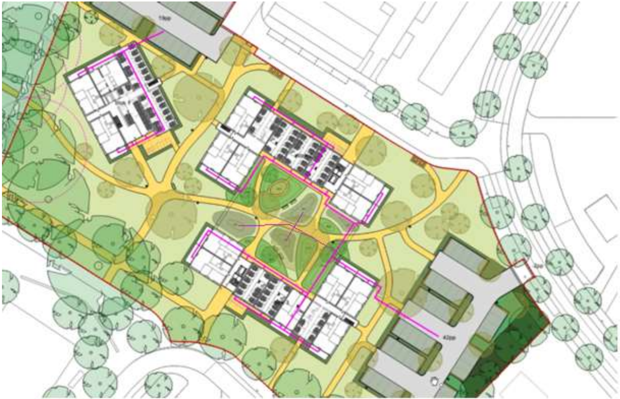
Figuur 6: Situatieschets van afvoerrichtingen van het hemelwater van de bouwblokken.
