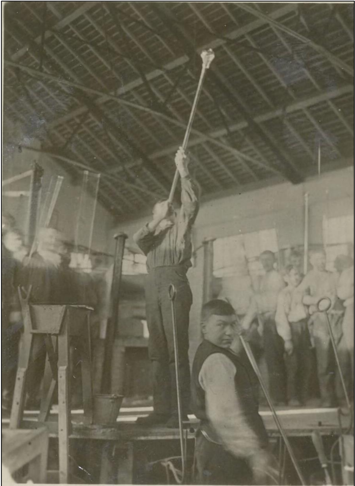
Het blazen van een ballon voor een gloeilamp (Nationaal Archief, NL-HaNA_2.24.03_73-groot).
