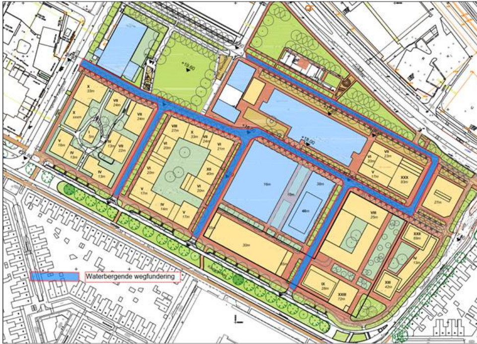
Figuur 2: Indicatie van locatie van waterbergende wegfundering.
