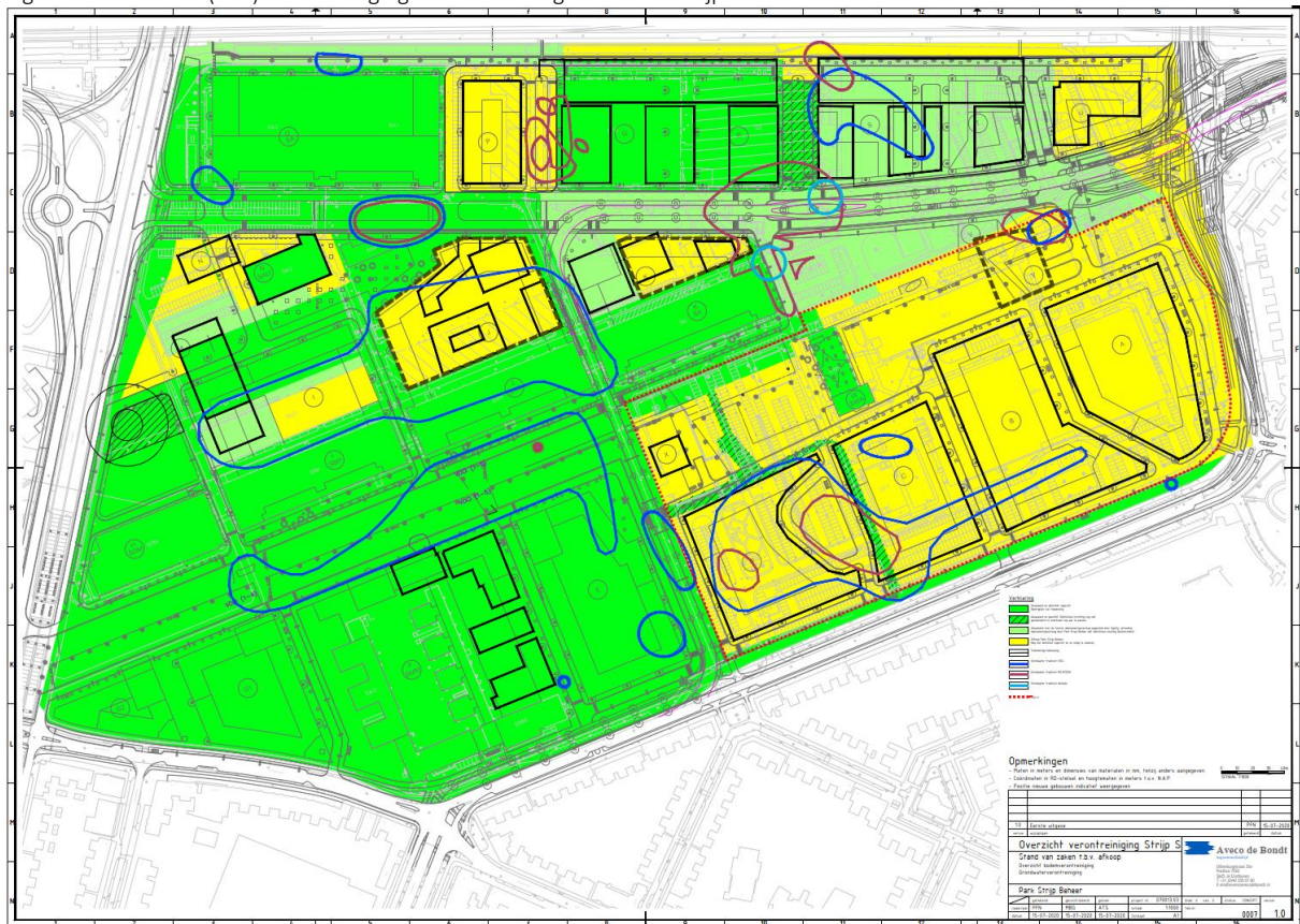
Figuur 2: Contouren (rest)verontreinigingen in freatisch grondwater Strijp-S
